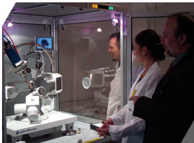
Rys. 2. Dyfraktometr czterokołowy do pomiaru monokryształów znajdujący się na Wydziale Chemii Uniwersytetu Wrocławskiego
